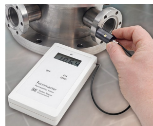
Ferromaster, l'instrument de mesure de la perméabilité
