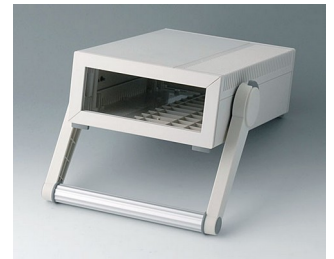
B2212107 MEDITEC E 220, avec poignée étrier ABS (UL 94 HB) gris blanc RAL 9002 160x260x74mm IP 40
