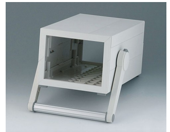
B2212317 MEDITEC E 220, avec poignée étrier ABS (UL 94 HB) gris blanc RAL 9002 160x260x124mm IP 40
