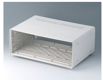
A0236170 EURO-BOITIER 63 T, sans poignée étrier ABS (UL 94 HB) gris blanc RAL 9002 367x250x143mm
