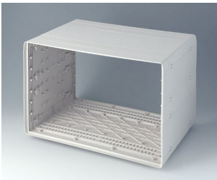
A0266070 EURO-BOITIER 63 T, sans poignée étrier ABS (UL 94 HB) gris blanc RAL 9002 367x250x276,5mm
