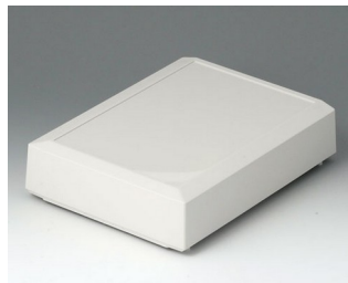
B4016657 Capot M, surélevé ABS (UL 94 HB) gris blanc RAL 9002 168x220x50mm
