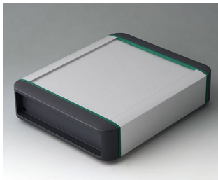
B3407011 SMART-TERMINAL 160 Aluminium AlMgSi 0,5 anodisé mat 202x170x50mm IP 54
