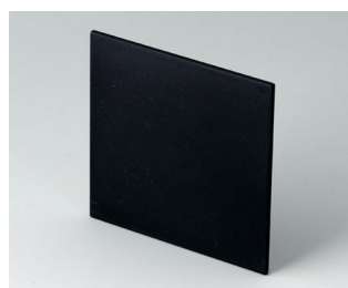
B6123221 Plaque avant PPO (UL 94 V-0) noir RAL 9005 67,6x67,6x2mm
