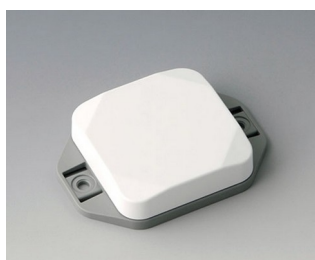
B1804126 MINI-DATA-BOX SF50, plate avec bride ASA+PC (UL 94 V-0) blanc signalisation RAL 9016 50x50x15mm IP 65 opt., IP 40
