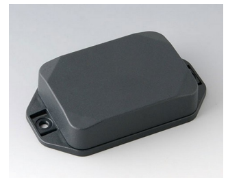
B1824228 MINI-DATA-BOX EF50, haute avec bride ASA+PC (UL 94 V-0) gris anthracite RAL 7016 70x50x20mm IP 65 opt., IP 40
