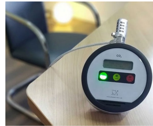
Feu de signalisation CO2
