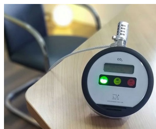
Feu de signalisation CO2
