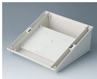
B4046827 Socle L - pupitre - ABS (UL 94 HB) gris blanc RAL 9002 183x183x73mm
