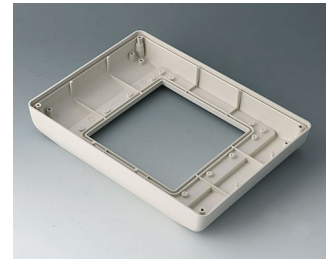
B4044757 Partie inférieure M surélevée, version I ABS (UL 94 HB) gris blanc RAL 9002 225x165x35,5mm IP 54 opt.
