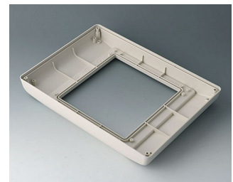
B4046757 Partie inférieure L surélevée, version I ABS (UL 94 HB) gris blanc RAL 9002 275x195x36,5mm IP 54 opt.
