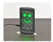
Appareil de mesure de l'air intérieur
