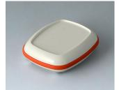
B1604207 BODY-CASE M, avec zone en creux ASA (UL 94 HB) blanc signalisation RAL 9016 50x41x14mm IP 65
