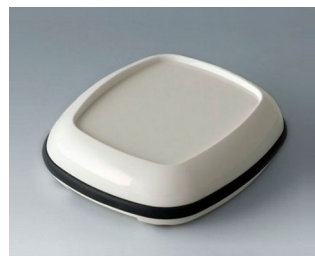
B1606217 BODY-CASE L, avec zone en creux ASA (UL 94 HB) blanc signalisation RAL 9016 55x46x16mm IP 65
