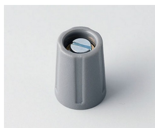
A2510048 BOUTON ROND 10, sans trait ABS (UL 94 HB) gris poussière RAL 7037 10x14mm 4mm
