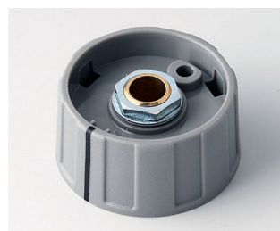
A2631068 BOUTON ROND 31, avec trait ABS (UL 94 HB) gris poussière RAL 7037 31x15mm 6mm
