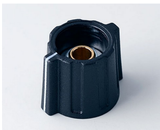
A2816060 BOUTON AVEC PAPILLONS 16, avec trait ABS (UL 94 HB) noir RAL 9005 16x15mm 6mm
