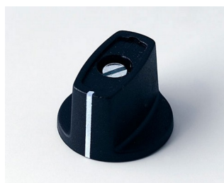
A2423040 BOUTON À BARRETTES 23, avec trait ABS (UL 94 HB) noir RAL 9005 23x16mm 4mm
