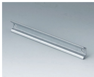
C7111087 Barrette normalisée, type TH 15 Acier 104x15x5,5mm
