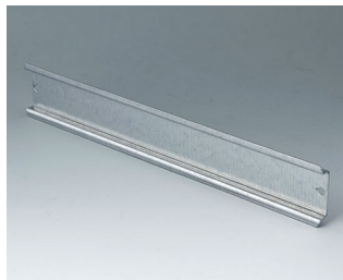
C7117077 Barrette normalisée, type TH 35 Acier 220x35x7,5mm
